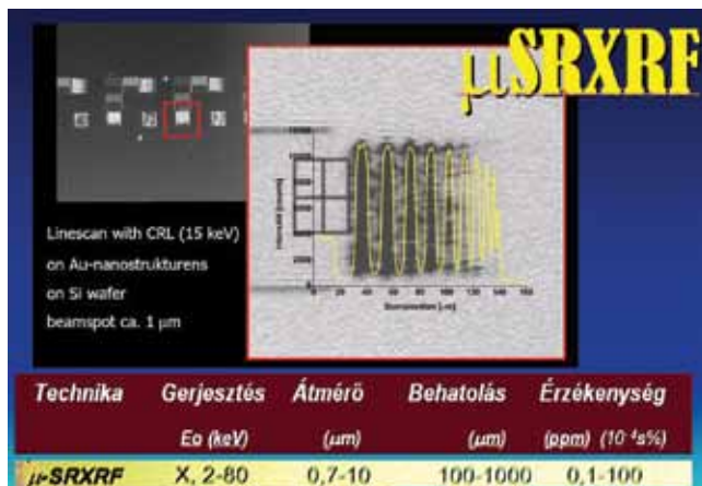
3. ábra. Si-ra párologtatott nanoszerkezet analízise.
