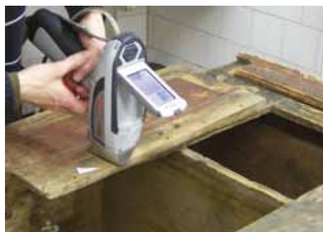
4. kép. A festékréteg vizsgálata kézi XRF készülékel.
