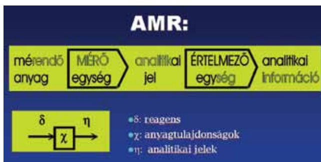
1. ábra. Az analitikai mérőrendszer és részei.
