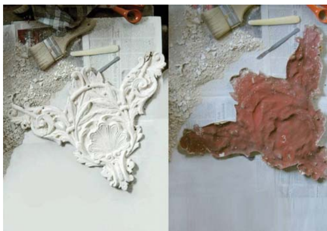
17. kép. Feltöltött üregű masé stukkó, elő- és hátoldal. (Orczy kastély, Gyöngyös, 19. sz., a szerző felvétele)
