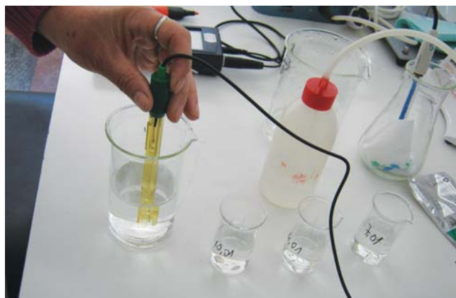
11. kép. A pH mérő műszer kalibrálása.
