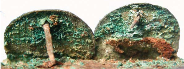
6. kép. Rézapplikációkon és környékükön a bőrborításon kialakult zsírkorrózió.
