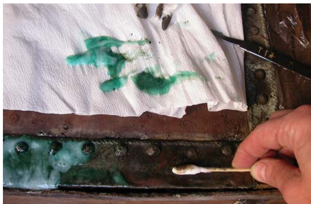
43. kép Rézlemez korrózió rétegének eltávolítása pasztásított komplexképző oldattal.
