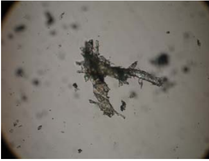
36. kép. Timsós cserzésű főkabór rostok melegítés előtt 20 °C-on. 13/1B minta.
