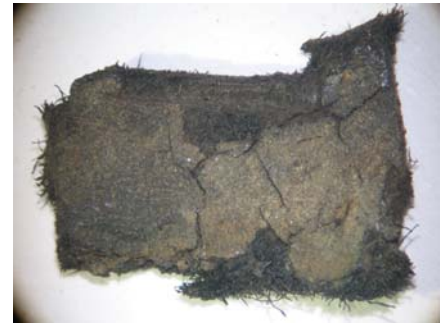
31. kép. Vaskorrózióval átítatódott, megfeketedett, megkeményedett bőrborításból vett minta. Mikroszkópos felvétel.
