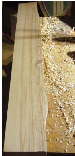
39-41. kép. Az Issekutz láda fedél- deszkája kiegészítésé- nek lépései. A pótlás a törésfelülethez illeszkedő kialakítása indigó segít- ségével.
