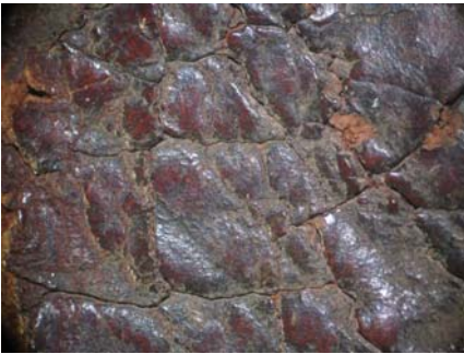
29. kép. Felületi szennyeződéssel borított, mikrorepedésekkel barázdált bőrborításból vett minta. Mikroszkópos felvétel.
