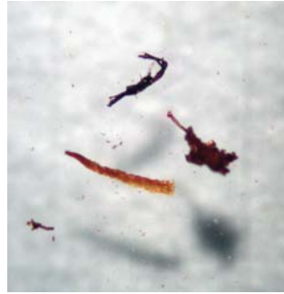
31. kép. Timsós cserzés kimutatása alizarin teszttel: a. rostok a nagyszebeni, 19. századi útiláda szőrös bőrborításából b. rostok színreakciója alizarin tesztre.
