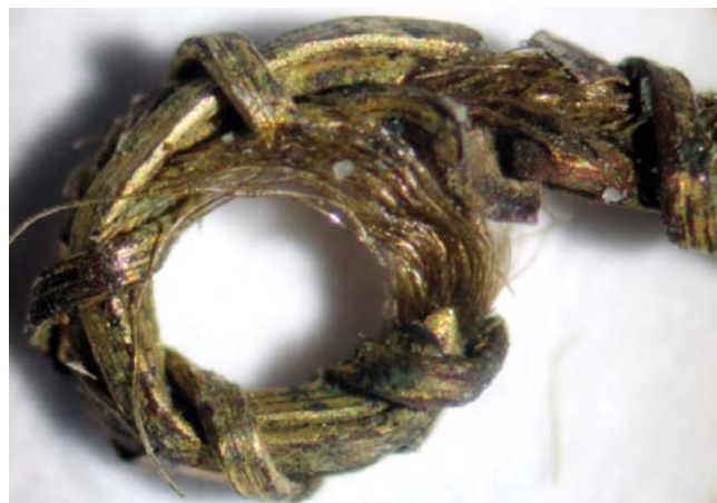
9. kép. 16. századi, bonyolult morfológiájú fémfonal: vastag, ezüstözött-aranyozott rézszalagok és egy bélfonal köré font aranyozott ezüst szalag egy további vastag, ezüstözött-aranyozott rézszalaggal összefogva.
