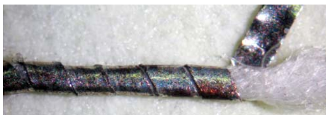
7. kép. Ezüstözött rézből készült fonal: ezüstözött rézdrótból hengerelt szalag fehér bélfonal köré fonva Z-sodratban.
