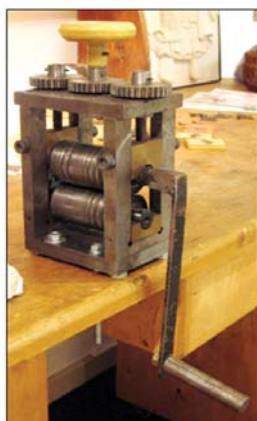
3. ábra. A drót elhengerlésének módja: a módszer elve Barker rajza alapján és egy – feltehetően 20. század eleji, hengerléshez használt, kézzel hajtható, dupla acélhenger. A kör keresztmetszetű drótból téglalap keresztmetszetű szalag lesz.
