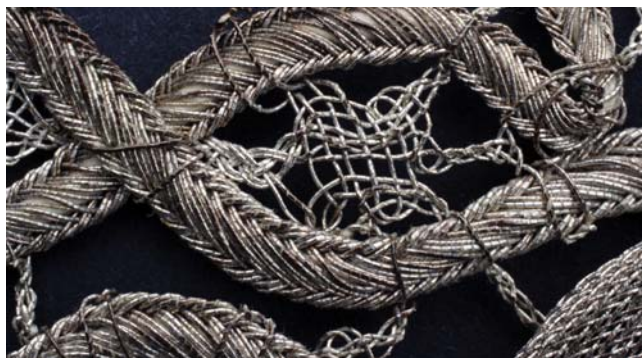
2. kép. „Hamis ezüsfonallal” készült csipke és annak részlete nagyobb nagyításban – ahol lekopott az ezüstréteg, előtűnik a réz vöröses színe.
