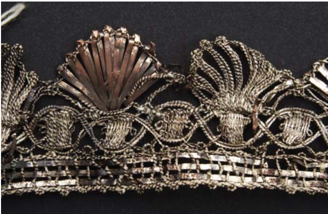
4. kép. Ezüstözött rézfonalból készült csipke és annak részlete, illetve ugyanez a csipke részleges tisztítás után. Az ezüsttisztító szer (savas tiokarbamidat, Argentol) leoldotta a fekete korróziós terméké alakult ezüstréteget – előtűnt a vörösréz alapfém. A tisztítással fontos készítésechnikai információk veszhetnek el.
