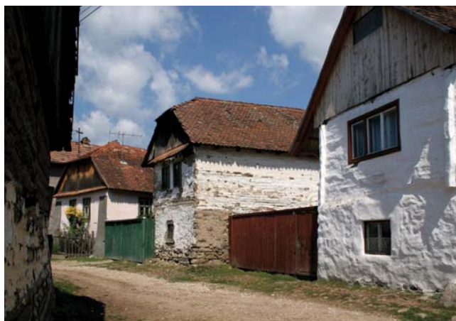
2. kép. A kő- és faépítkezés (boronafal) ötvözése révén emelt lakóházak – Lovéte.
