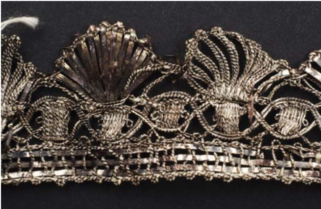
3. a. kép. Zöldes korrózió az eredetileg aranszínű paszománnyon (a rézalapú fonal nedvesség és a légszennyezők hatására helyenként zöldszerűvé alakult).
