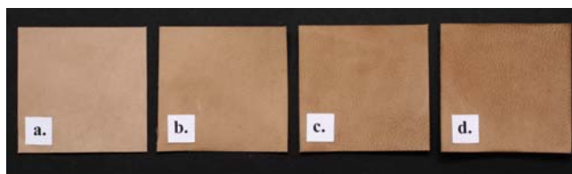
11. kép. Tisztítási kísérlet különböző összetételű keverékekkel. Az „a” jelű bőr kezeletlen, „b”-től „d”-ig egyre növekvő víztartalmú likkerekkel áttörölt mintadarabok.
