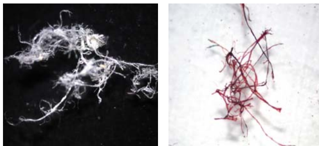
30. kép. Timsós cserzés kimutatása alizarin teszttel: a. rostok új, timsós cserzésű szőrös foka bőr mintából, b. a rostok színreakciója alizarin tesztre.
