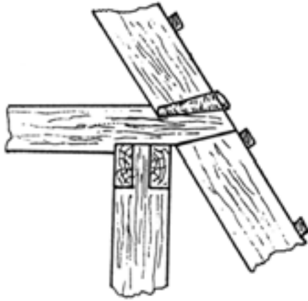
8. ábra. A vízcsendesítő, szarufa rögzítése a koszorúgerendához.
