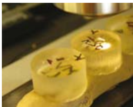
16. kép. A keresztmetszet csiszolatokat felső megvilágításban vizsgáljuk. Több mintát is be lehet ágyazni egy tömbbe, csak fontos hogy pontosan feliratozzuk, jelöljük a mintán.
