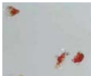
30. kép. A szemcsepreparátum részben keresztezett polarizátoránál.
