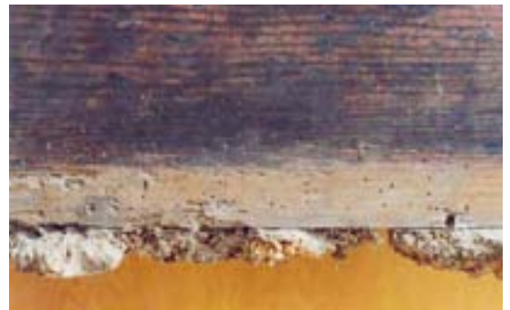
9. kép. Részletfelvétel egy rovarfertőzött ládáról. A profilécet festés előtt rögzíthették, mivel nincs alatta festék.
