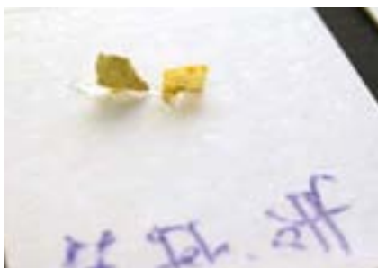
11. kép. A minta felragasztása, szilikonos lapra pillanatragasztóval. Nagyon fontos, a feliratozás!
