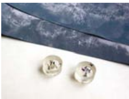
15. kép. Megcsiszolt minták a műanyaggyűrű eltávolítása után. Nagyon fontos, hogy a mintán szerepeljen a száma, mert nem tudjuk azonosítani! Célszerű belekarcolni is, mert az alkoholos filccel készített felíratok lekophatnak a csiszolás során.
