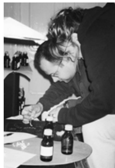
9. ábra. Oldódási próbák oldószer teszt sorok segítségével.
