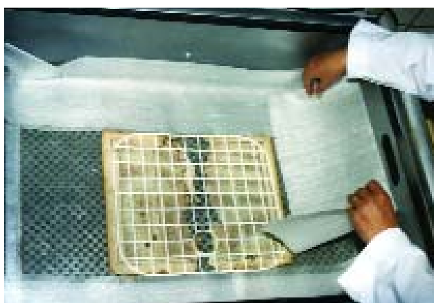
5. kép Az öntés előkészítése, leszorítás
