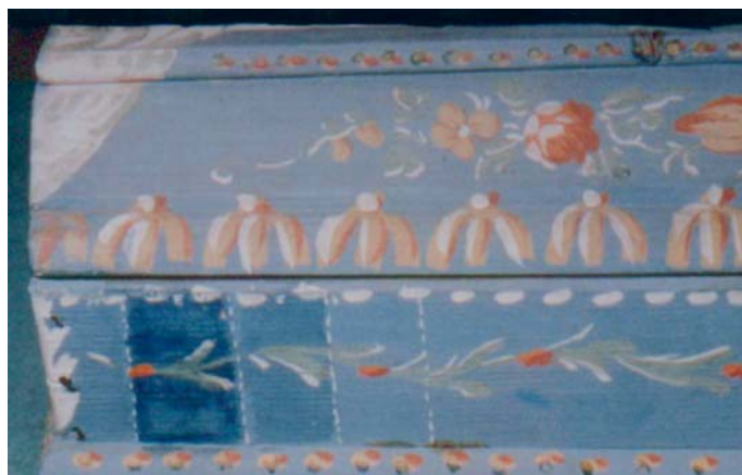
21. kép. Próbák porlékony festékréteg megkötésére különböző oldatokkal
