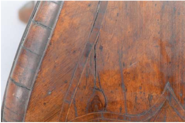
1. kép. A levegő alacsony páratartalmának (RH) következtében megrepedezett borítás
