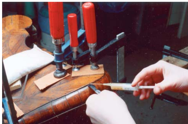
4. kép. Enyv bejuttatása felvált borítás alá
