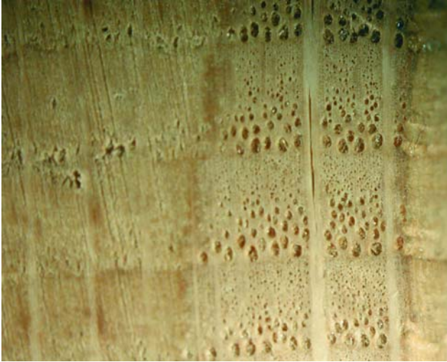
1. kép. Tölgyfa minta mikroszkópos képe 20x nagyításban. A felvételen látható az évgűrűk bő üregűtavaszi sejtjei és a szűk üregűnyári sejtjei. Jól látható a mikroszkópos vizsgálathoz vágással kialakított éles felület, amit két oldalról durva fűrészelt felület fog közre.
