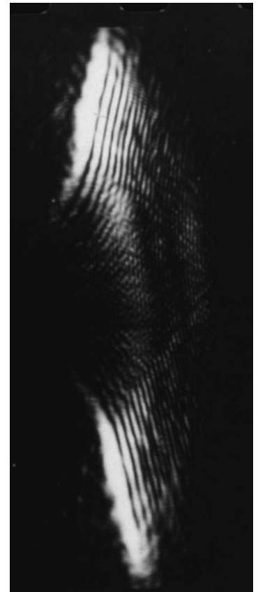
5. ábra. A hologram gyűrű alakú részéről rekonstruált fókuszfoltok a szagittális fókusz síkban 6 mrad szöghiba mellett. Balra: számított görbék \rho = 10, 15, 20 és 25 mm sugarú körökről. Jobbra: a 20 mm középsugarú gyűrűről rekonstruált kép mikrofotója.
