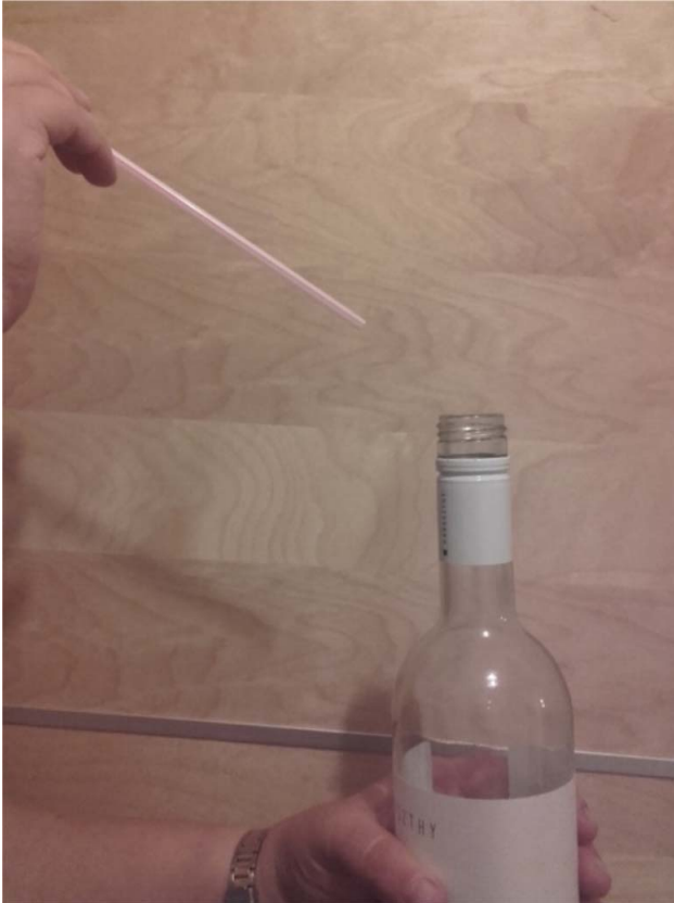
1. ábra. Borosüveg megszólaltatása szívószálon keresztül kifújott levegővel. Az üveg megszólaltatásához a szánból kiáramló levegő neki kell ütközzön az üvegnyak belső peremének.
