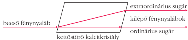
13. ábra. Sematikus rajz a kalcitkristály fénytöréséről.
