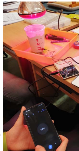
1. ábra. A „talaj”-hőmérséklet változása a felszín alatt 1, 4 és 7 cm-es mélységben a hőszugárzás időtartamának függvényében és a mérés összeállítása Arduinóval.
