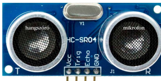
1. ábra. A HC-SR04 áramkör fényképe.
