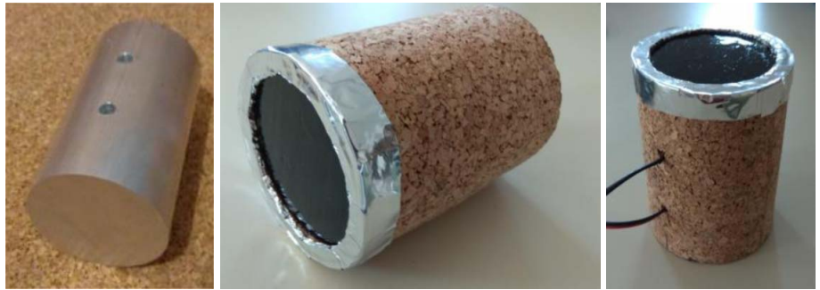
12. ábra. Az alumínium kaloriméter készítésének lépései.
