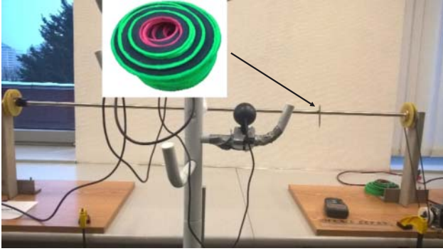
5. ábra. Az olajoztgyűrűk-probléma kísérleti összeállítása. Az ábrába szerkesztett kis képen a kísérletekben használt gyűrűk láthatók.
