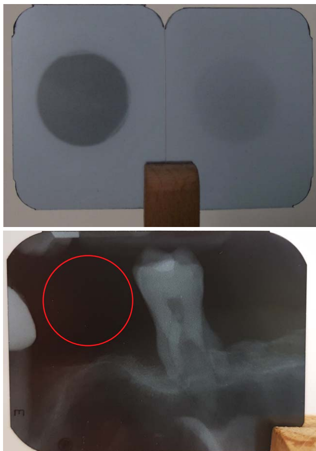
4. ábra. Fent besugárzott filmek: röntgenső, fél perc és jobbra Am-241, hét nap. Lent korszerű röntgengéppel készített fogászati röntgenfilm fél másodperces besugárzási idővel.
