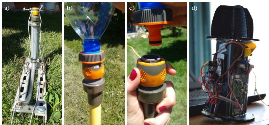
3. ábra. a) A vízirakéta kilövőállása a földhöz rögzítve. b) és c) Palack csatlakoztatása és kioldása. d) A tartórészre felszerelt elektronika [1].
