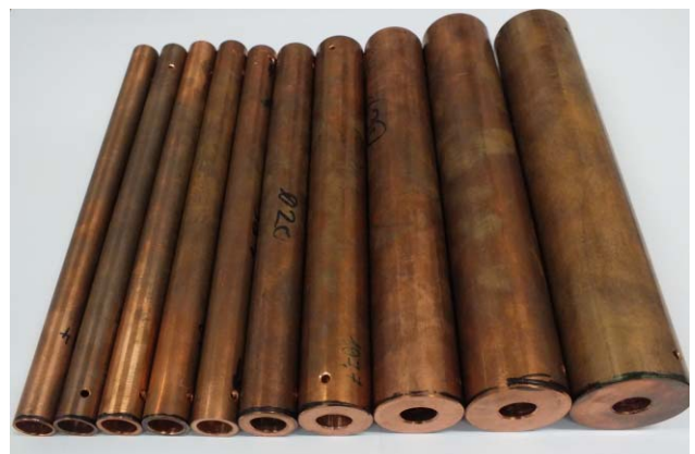
5. ábra. A mérésekhez használt rézcsövek a végek közelébe fúrt lyukakkal.
