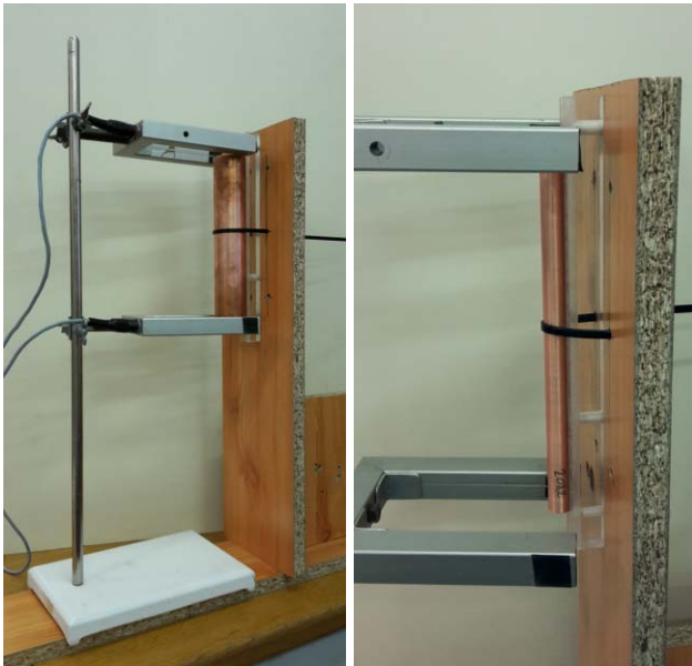
3. ábra. A mérési összeállítás: fénykapu és mintatartó állvány.
