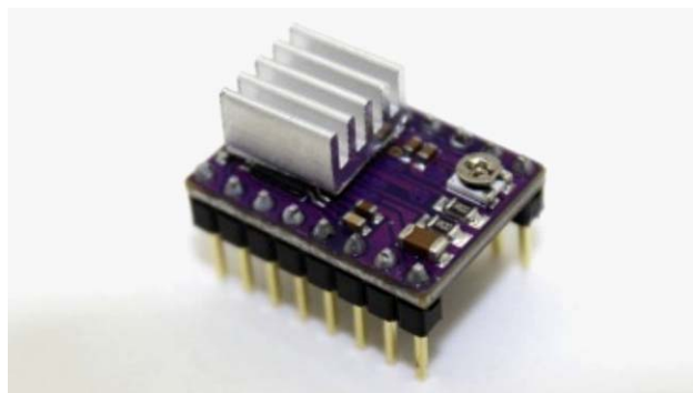
3. ábra. Bipoláris léptetőmotort vezérlő.
