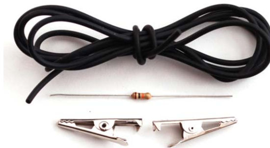
3. ábra. A vezető gumiszál a hozzá kapott 2 krokodilcsipessel és az 1 k\Omega -os ellenállással.
