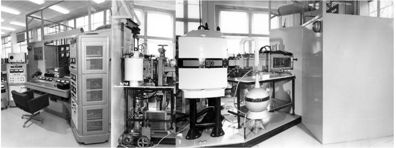
3. ábra. A Kurcsatov Intézet tömegszeparátor típusú, azaz nagyáramú 40 kV-os gépe.
