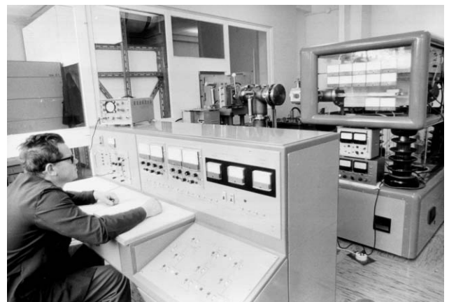
4. ábra. A saját fejlesztésű 150 kV-os, a bal oldalon lévő tiszta laborba „szolgáló”, precíz adalékolásra alkalmas implanter, SAFI.
