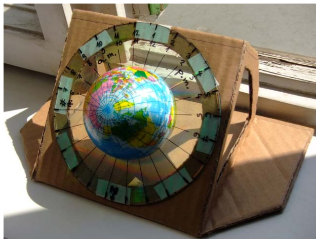
9. kép. A télen és nyáron is használható, átlátszó CD-napóra.
