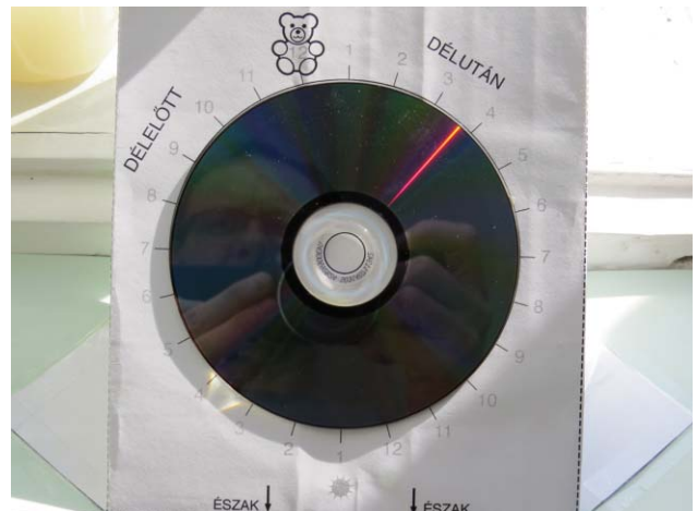
4. ábra. Nyáron használható ekvatoriális CD-napóra.
