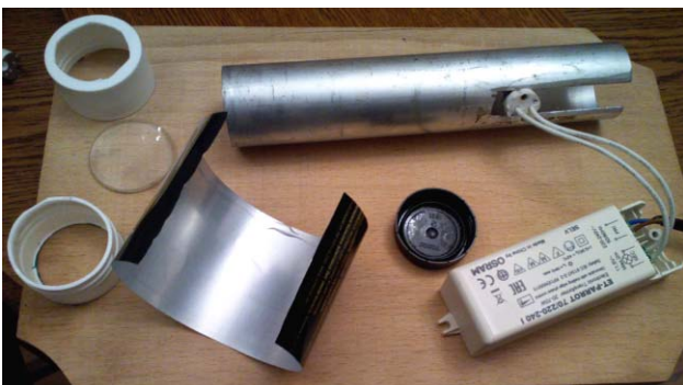
3. ábra. A fényforrás alkotó elemei (fölül) és az összerakott fényforrás (alul).
