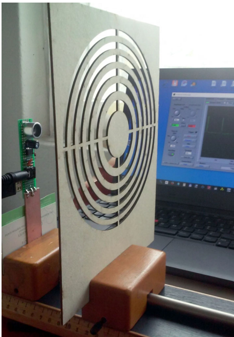
12. ábra. Az elkészült Fresnel-lencse mérés közben.
