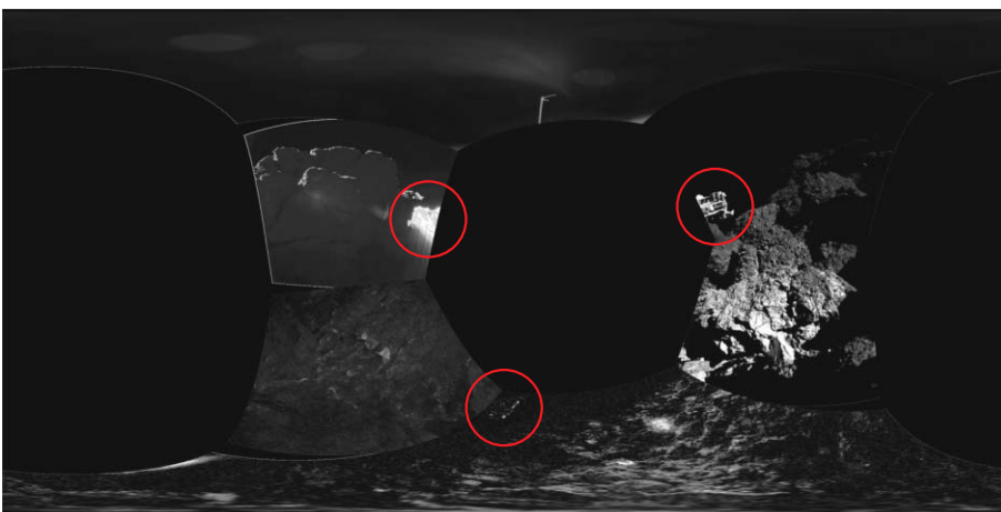
A Philae CIVA kameráival leszállás közben készített képek összemontírozva. A karikákkal a lábak látható részei vannak jelölve a felszín háttérében (forrás ESA).
