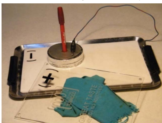
9. ábra. Bíró Tibor házilag összeállított elektroforja.
