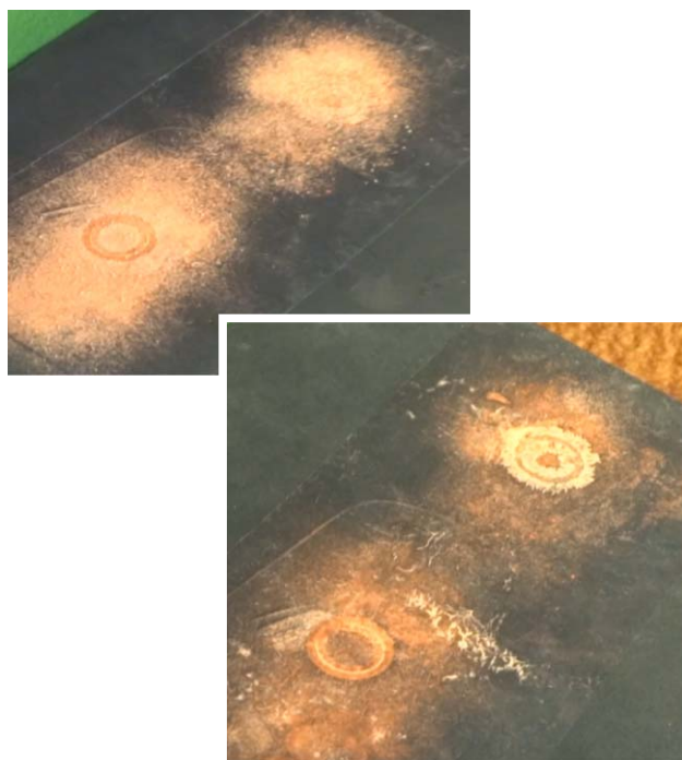
17. ábra. Lichtenberg-ábrák a fölösleges mínium- és kénpor keverékének eltávolítása előtt (föül) és lefújás után (alul).
