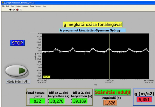
4. ábra. A LabView kijelzője a nehézségi gyorsulás fonálingás meghatározásakor.
