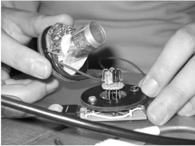
2. ábra. A diákok által épített LED spektrométer.
