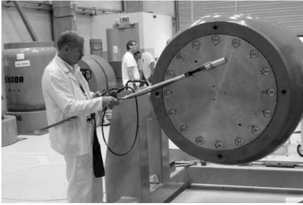
3. ábra. A betöltött VPVR/M konténer sugárvédelmi ellenőrzése.
