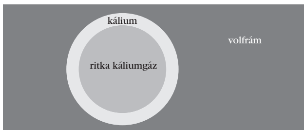
5. ábra. A volfrámba ágyazott káliumbuborék belsejének vázlata.
