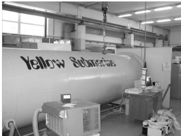
1. ábra. Yellow Submarine kisszögű szórásvizsgáló berendezés fényképe.
