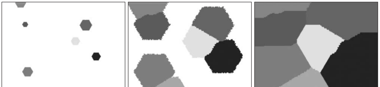
3. ábra. Ez a számítógépes szimuláció a CVD grafén kristallitok növekedését mutatja. A szemcsék növekedése mindaddig tart, amíg összeérnek. A különböző szürkeárnyalatok a különböző kristálytani orientációknak felelnek meg. (Philippe Lambin (Namuri Egyetem, Belgium) szimulációja.)
