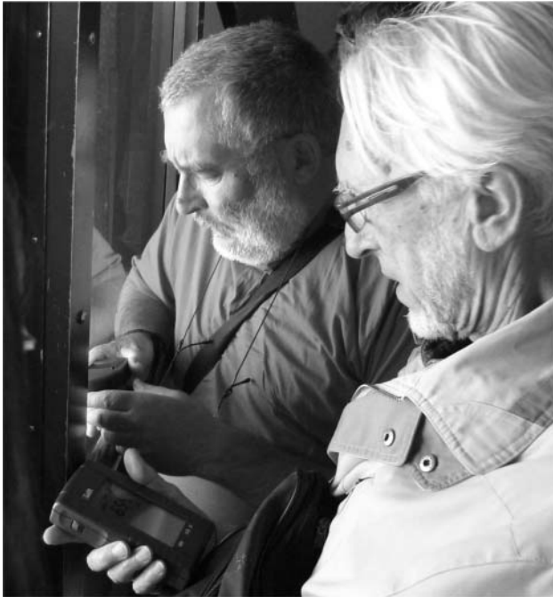
2. ábra. Egyidejű légnyomásmérés és helymeghatározás a felvonókabin ablakánál a pontos magasságmeghatározás érdekében.
