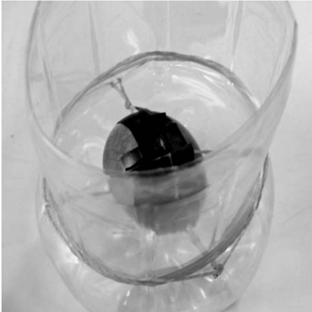
2. ábra. A félbevágott flakonhoz gumival és szigetelőszalaggal rögzítettük a tojást.
