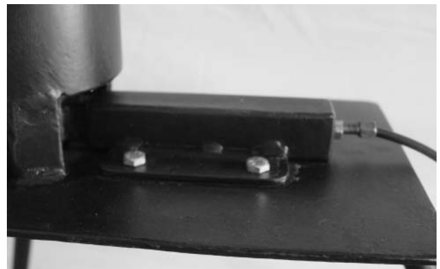
8. ábra. A reteszelő zárszerkezet.
