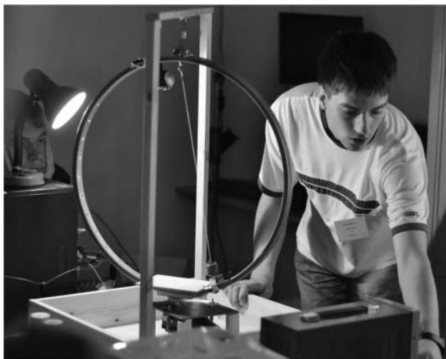
9. ábra. A diákkörös tanulók saját forgó rendszert fejlesztettek, amelyben webkamerás és wiifiz módszerrel is vizsgálják a mozgásokat, folyamatokat.
