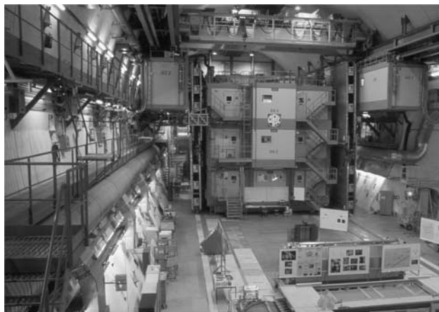
5. ábra. Az OPAL-detektor a LEP barlangjában. Az elektronikus barakkok szemben és kétoldalt közvetlenül érintkeznek a detektorrendszerrel, de eltávolíthatók a detektor javításához.
