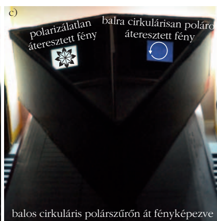
8. ábra. Az előkísérletben és a 6. kísérletben használt testdoboz. a) a testdoboz kívülről nézve. b) a fejről állított testdoboz belsejét polárszűrő nélkül nézve, az egyik ablak BCP-fényt eresztett át, míg a másikon keresztül polarizálatlan fény érkezett a dobozba. c) a fejről állított testdoboz belseje egy BC polárszűrőn át fényképezve.
