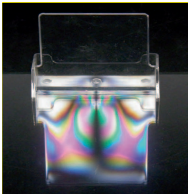
2. ábra. A polarizált fény polarizációsíkja névjegykártya-tartón áthaladva – a mechanikai feszültség függvényében – elfordul. Az üveglapról Brewster-szögben visszaverődő fényben láthatóvá válnak a csíkok.
