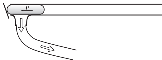
5. ábra. A porszívós ágyú működése, fölül porszívó bekapcsolása, cső lezárása, lövedék behelyezés, alul a kilövés a megfelelő vákuum elérése után.
