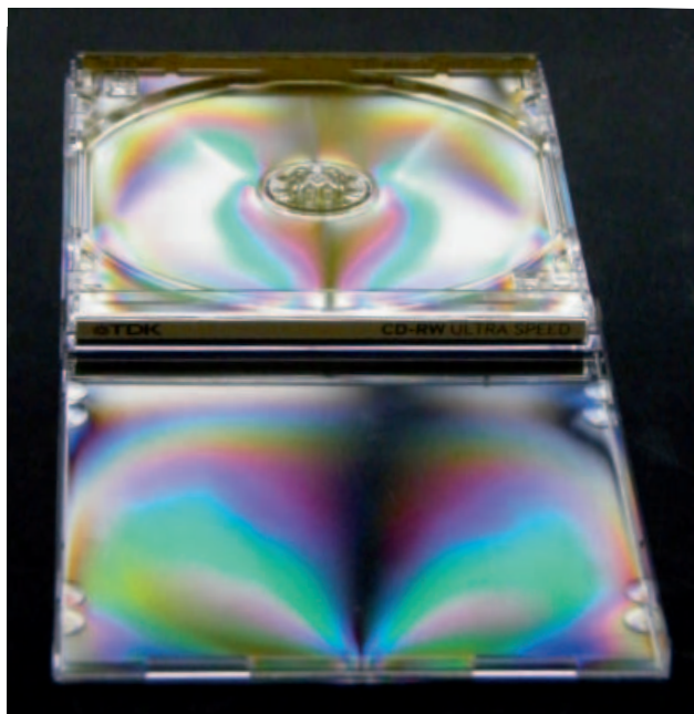
1. ábra. A polarizált fényel megvilágított CD-tokon megtört fény a hátsó felületről visszaverődve jut el a szemünkhöz. A Brewster-szögben választva megjelennek a feszültségoptikai csíkok.
