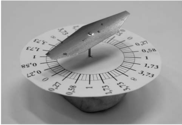
4. ábra. A házilag készített iránytű és a tangensskála.
