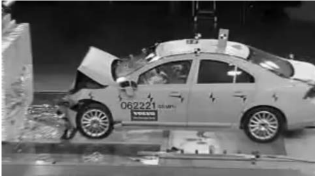
6. ábra. Frontális ütközés 64,4 km/h-val. A felvételen látható a karosszéria első részének deformációja, de ugyanakkor a rugalmas visszalökődés is.
