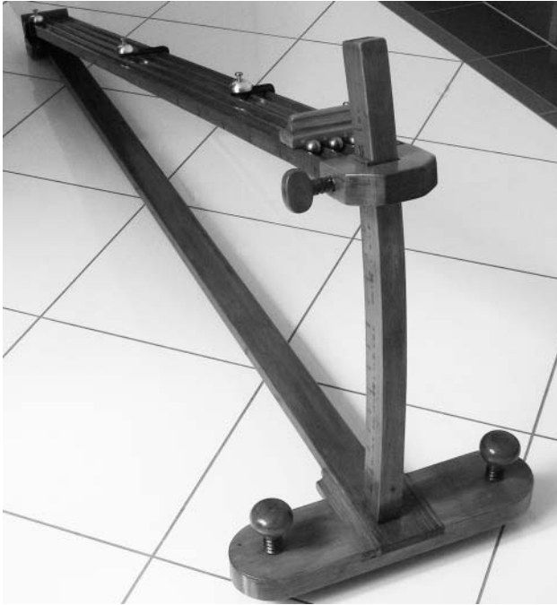
4. ábra. Galilei-lejtő. A gyönyörűen felújított, mintegy 100 éves, négy-csatornás Galilei-lejtő. A négyzetes úttörvény szerint növekvő utak megtételéhez tartozó időtartamokat a lejtőn elhelyezett csengők jelzik.
