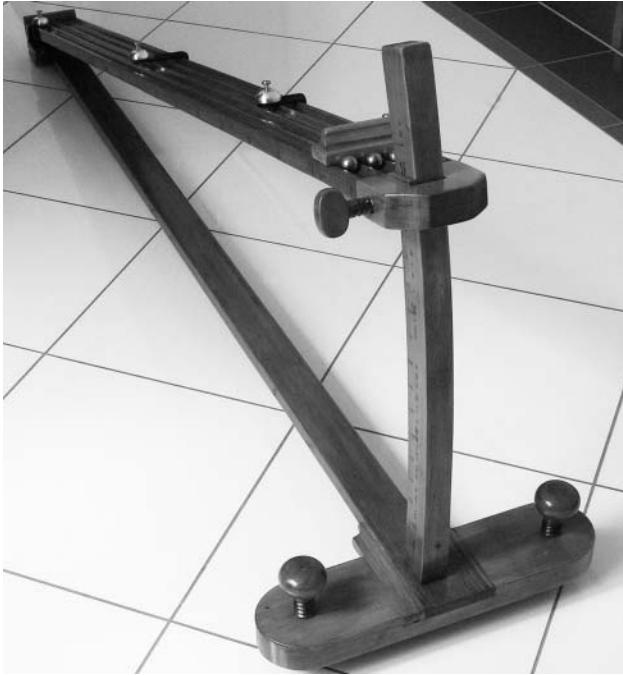
4. ábra. Galilei-lejtő. A gyönyörűen felújított, mintegy 100 éves, négy-csatornás Galilei-lejtő. A négyzetes üttörvény szerint növekvő utak megtételéhez tartozó időtartamokat a lejtőn elhelyezett csengők jelzik.
