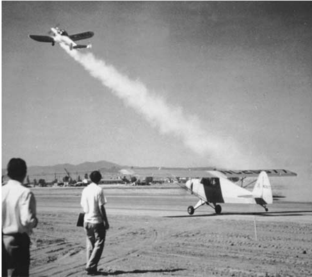
Az amerikai légierő vadászgépének első, sugárhajtómű segítségével végrehajtott felszállása 1941-ben. A „rakéta-segítette” felszállás rövidebb kifutópályát igényelt, így a repülőgép-anyahajókról a lomhább bombázógépek is el tudtak indulni.
