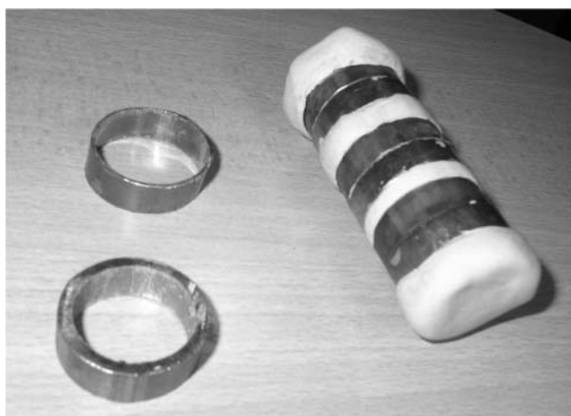
6. ábra. Három-három vas- és rézcsődarabból kialakított cella.
