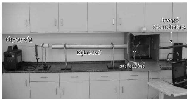
1. ábra. A vízszintes helyzetű, elektromosan fűtött Rijke-cső.
