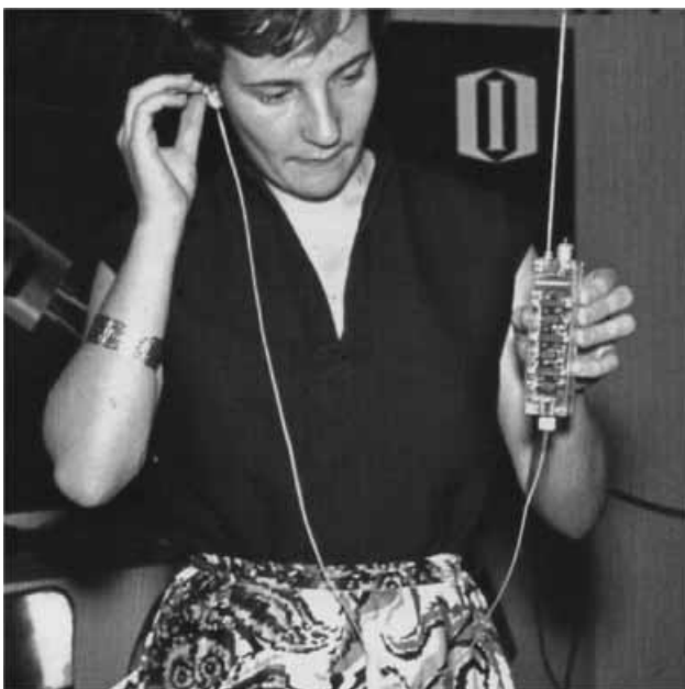
18. ábra. Az 1953-as düsseldorfi rádió-kiállításon bemutatott négy tús transztront tartalmazó rádió.
