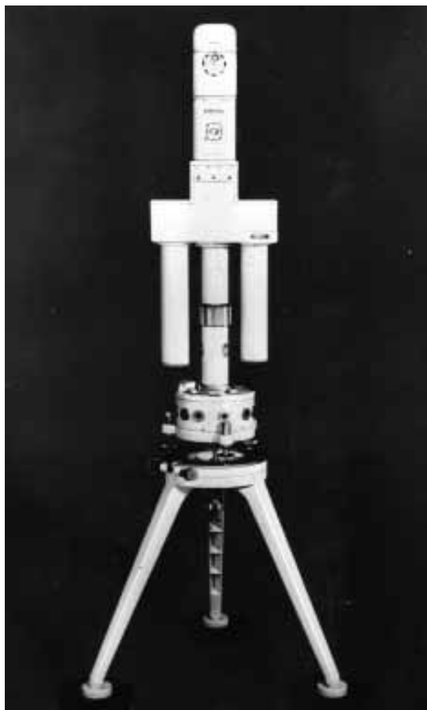
13. ábra. A Rybár-féle E 54 típusú torziós inga
