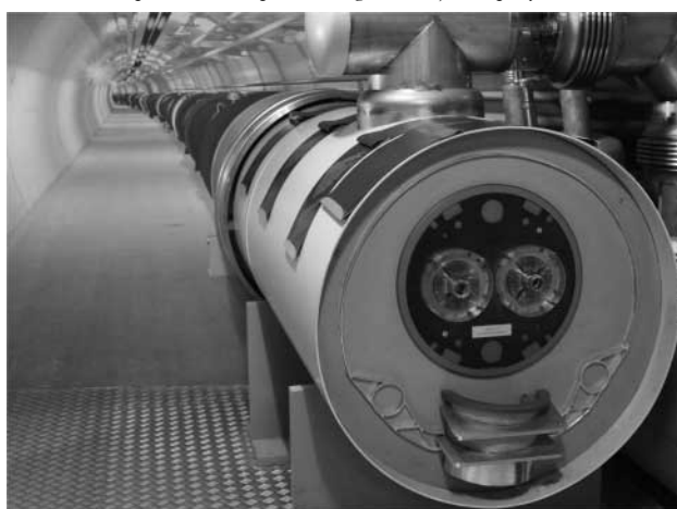
3. ábra. Az LHC eltérítő-mágnesének keresztmetszete a CERN Mikrokosmosz kiállításán. Az egymással szemben keringő és az észlelőrendszerek középpontjában ütköztetett, 7 TeV energiájú protonnyalábot két szupravezető dipólus-mágnes tartja körpályán 8,3 T téréll.
