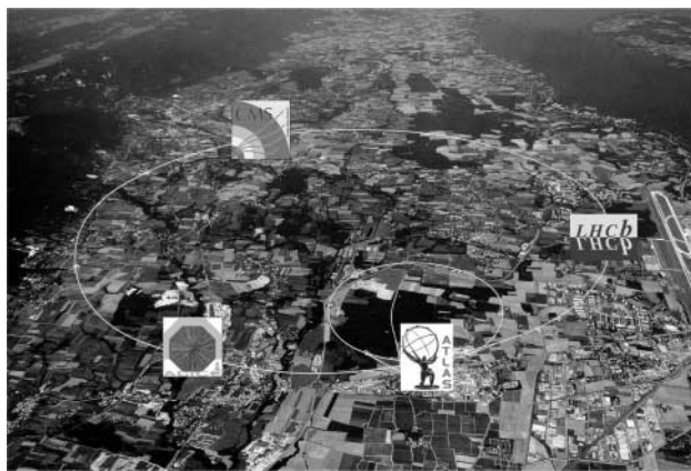
2. ábra. Az LHC és kísérletei. A két kisebb kísérlet, az ALICE és az LHCb elfért az L3 és DELPHI LEP-kísérletek barlangjában, de a két nagy, a CMS-nek és az ATLAS-nak új gödröt kellett ásni.
